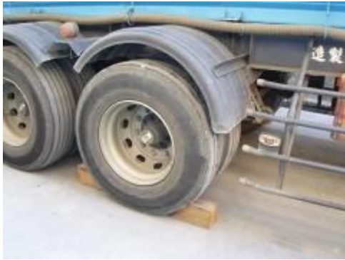
裝設車輪擋固定
