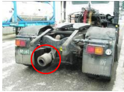
排氣管裝設滅焰器
