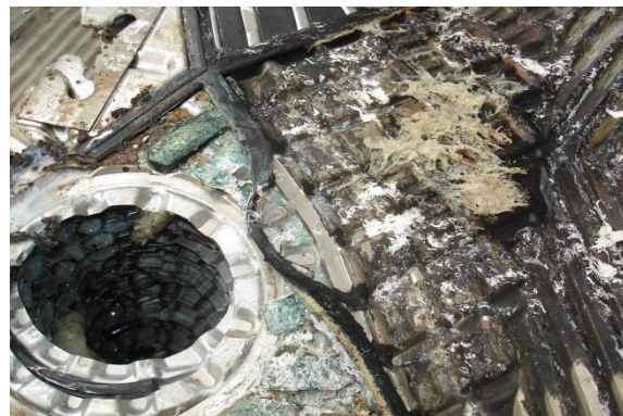
Field Gasket 使用液態氮冷凍除膠
