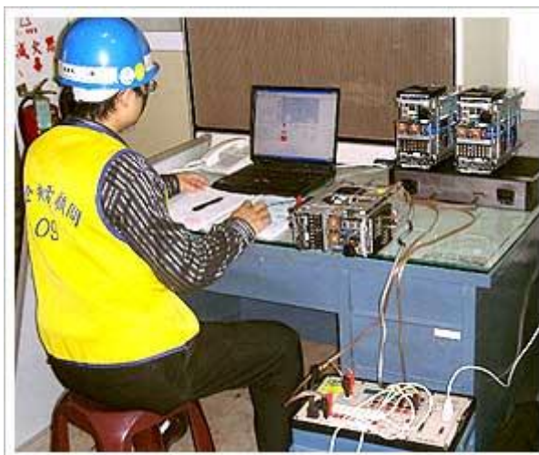
圖 2.3.6 保護電驛檢測
