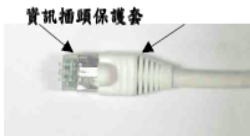
圖 2.3.37 套上電纜保護套
