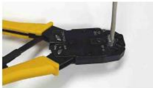
圖 2.3.36 專用壓接工具壓接電纜
