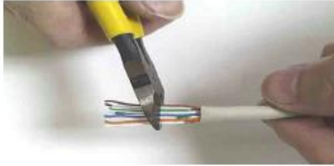
圖 2.3.33 VUP 心線使用斜口鉗修齊
