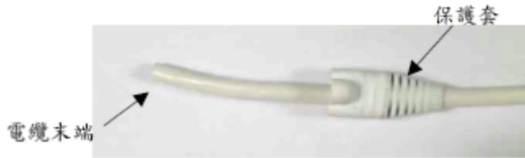
圖 2.3.30 保護套套進網路線
