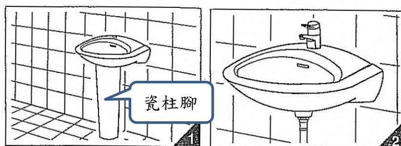
圖 2.3.4 臉盆(附瓷柱腳)安裝示意圖
