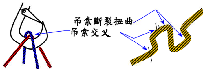
圖 2-12 吊索不可交叉亦不得斷裂扭曲
