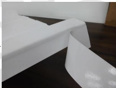
貼合邊緣底材裸露處
