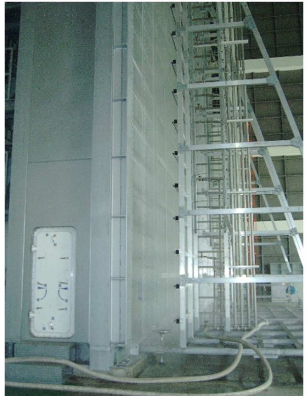
圖 2.6.1-5 大型噴水架側面 (使用帷幕牆水密試驗)
