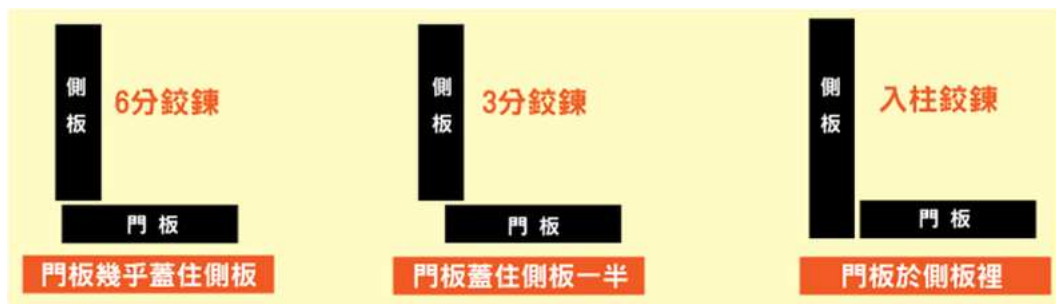
圖 2.1.7-2 門板鉸鍊入柱、蓋柱示意圖
