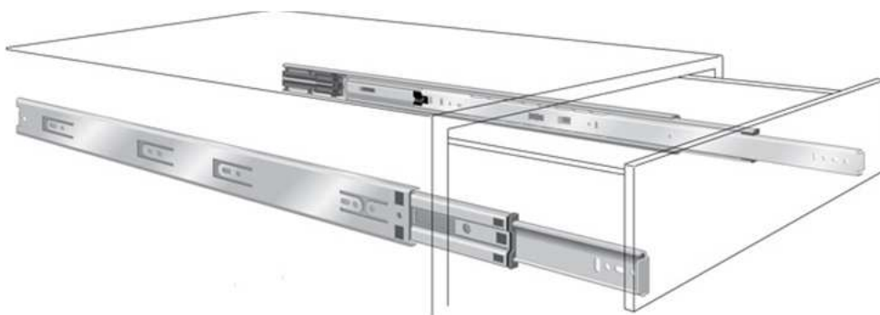
圖 2.1.7-3 門板鉸鍊(圖例為三節滑軌)
